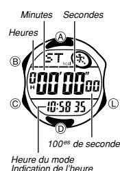
Le chronomètre d'exercice mesure le temps écoulé, des temps partiels et deux arrivées au 100<sup>e</sup> de seconde près. Il utilise les données saisies en mode Saisie des données de base et un signal rythmique pour calculer le nombre de calories brûlées et la distance parcourue pendant un jogging ou une course.
