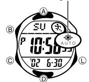
Le rétroéclairage emploie un panneau EL (électroluminescent) qui éclaire tout l'afficheur pour qu'il soit mieux visible dans l'obscurité. L'autocommutateur de la montre allume automatiquement le rétroéclairage lorsque vous tournez la montre vers votre visage.
