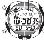
Le rétroéclairage utilise un panneau EL (électroluminescent) qui éclaire tout l'afficheur pour le rendre mieux visible dans l'obscurité. L'autocommutateur de la montre active le rétroéclairage lorsque vous tournez la montre vers votre visage.
