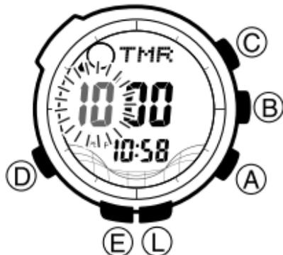
1. Pendant que le temps initial du compte à rebours est affiché en mode Minuterie de compte à rebours, appuyez sur (E) jusqu'à ce que le réglage du temps initial du compte à rebours se mette à clignoter, ce qui indique que l'écran de réglage.
