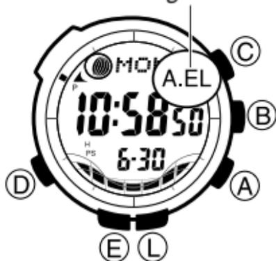
Un panneau EL (électroluminescent) éclaire tout l'afficheur de la montre pour qu'il soit mieux visible dans l'obscurité. L'autocommutateur d'éclairage de la montre s'active lorsque vous tournez la montre vers votre visage et à ce moment l'afficheur s'éclaire.
