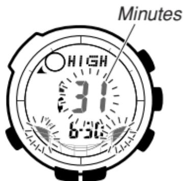
2. Lorsque les informations de la lune (âge et phase de la lune) et les informations de la marée (niveau et amplitude de la marée actuelle) sont affichées, appuyez sur (E) jusqu'à ce que les chiffres des heures se mettent à clignoter. C'est l'écran de réglage des heures de marée haute.
