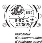
Cette montre a un panneau EL (électroluminescent) qui éclaire tout l'afficheur pour qu'il soit mieux visible dans l'obscurité. L'autocommutateur d'éclairage de la montre éclaire l'afficheur lorsque vous tournez la montre vers votre visage.
