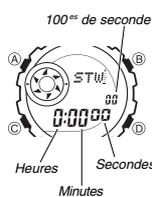
Le chronomètre permet de chronométrer des temps écoulés, des temps partiels et deux arrivées.
