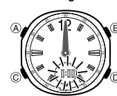
Korrekte Stellungen von Stunden- und Minutenzeiger
